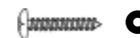
Rostfri skruv för infästning av skarvlist 19x4,2 50-pack för 10mm skivor 25x4,2 50-pack för 16 mm skivor 45x4,2 50-pack för 32 mm skivor
